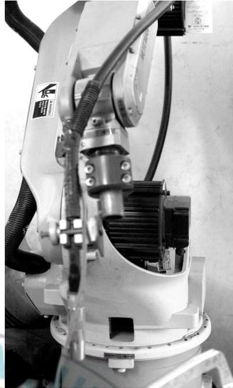
Fig. 3.4 Used Robot (MOTOMAN HP 6)
