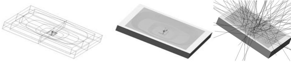
[그림 30.] LightTools 시뮬레이션 조건, LED PKG 설계도면 그리고 시뮬레이션 캡처
