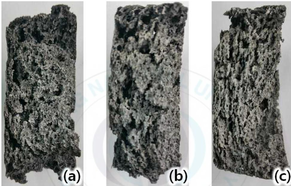
그림 4-1. 알루미늄이 (a) 5 g, (b) 10 g, (c) 15 g 첨가된 알루미늄 발포체의 단면 사진
