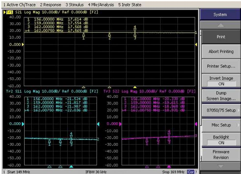
[그림 24] LNA 회로 실험결과
