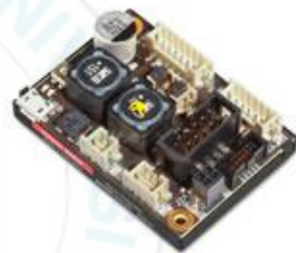
(d) Maxon motor driver (ESCON 36/2 DC)
