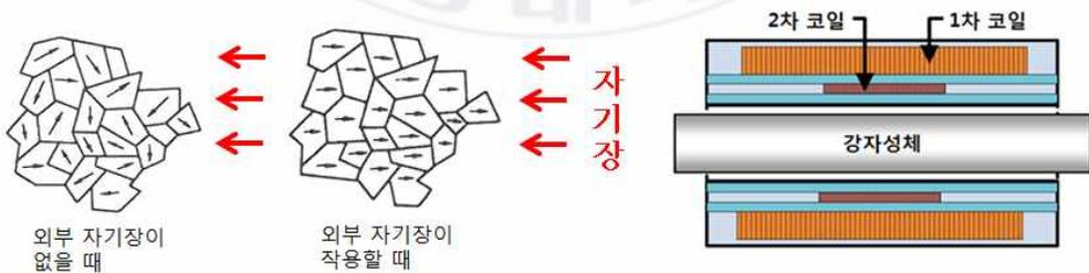
그림 2.3 Elasto-magnetic Sensor
