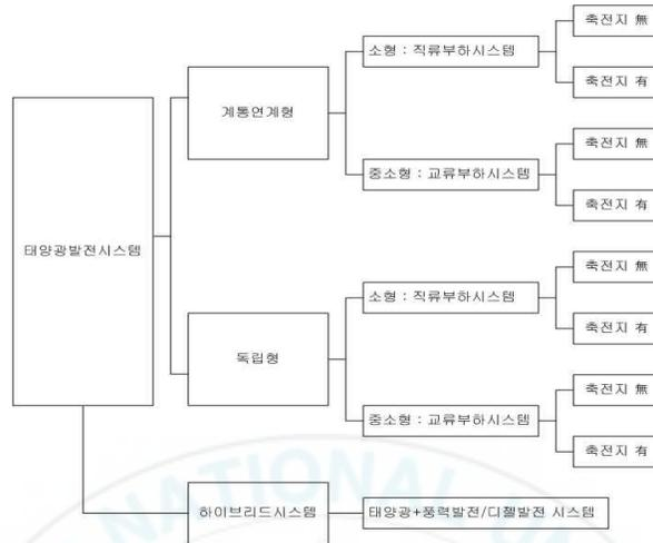
그림 2.1 태양광 발전 시스템의 분류
