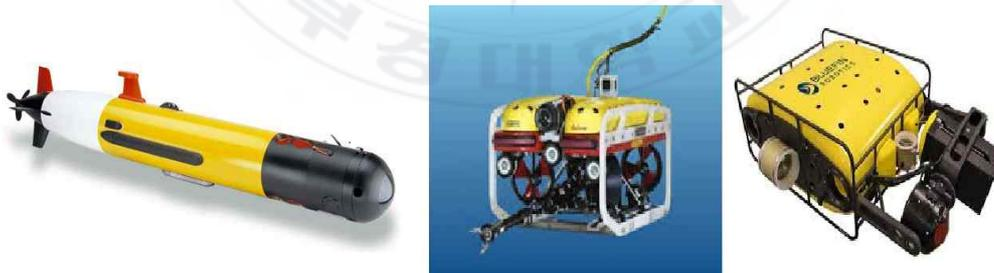
그림 1. AUV, ROV, HAUV의 형태
