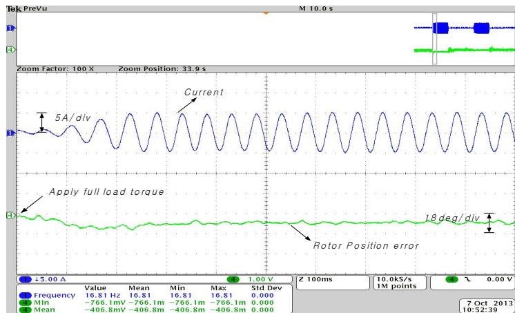
그림 5.12 기존의 전류 추정기를 적용한 경우 상전류 및 회전자 위치 오차(Ld 오차가 존재할 경우)
