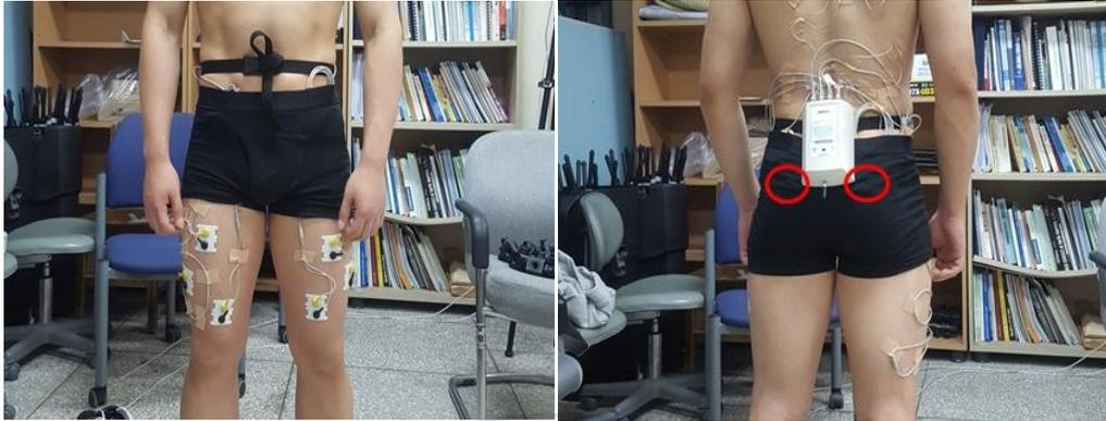
그림 11. 본 실험의 근전도 센서 부착위치
