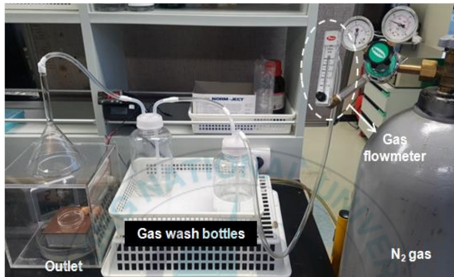
[그림 15] Breath Figure법을 위한 실험 장치
