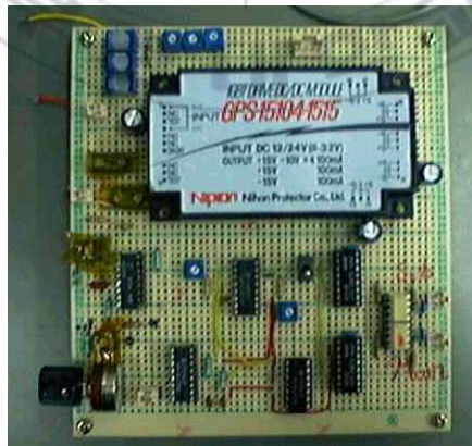
사진 1 실험에 사용된 태양광 발전용 SPWM 인버터 시스템
