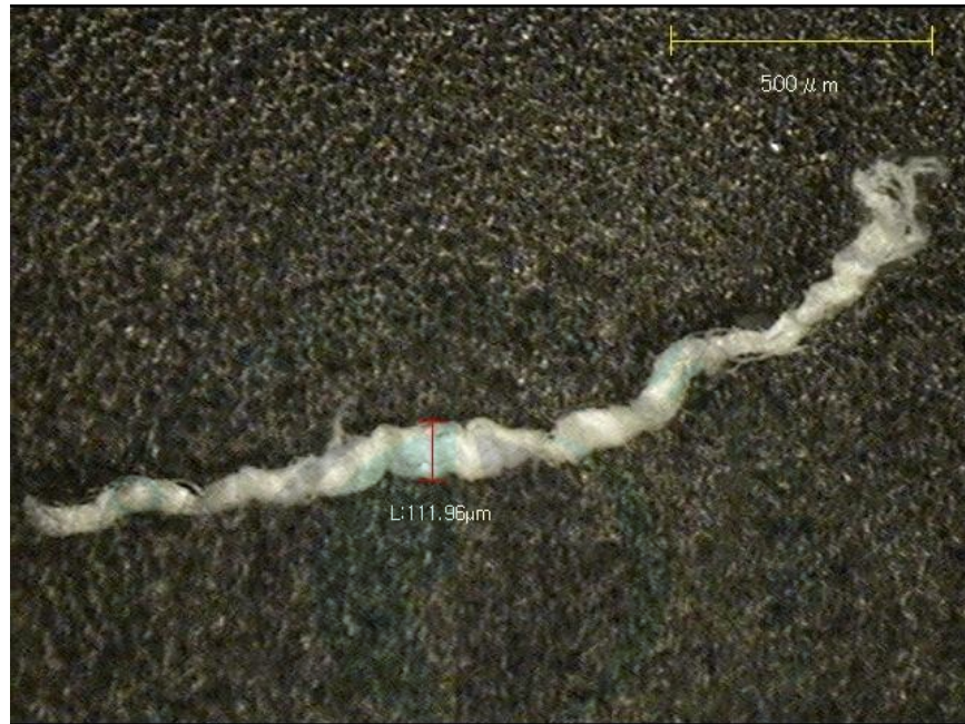
Figure 3. Shaving scrap의 현미경 사진.
