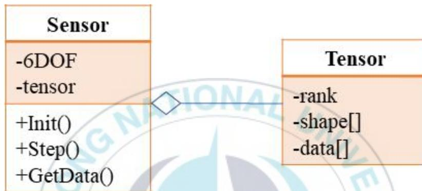
그림 3-9 Sensor와 Tensor의 다이어그램
