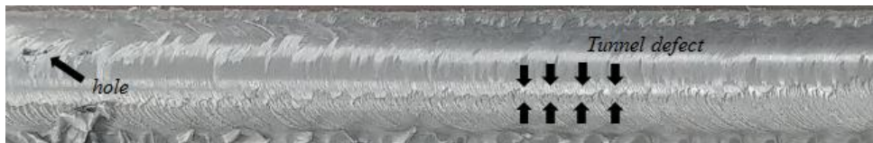
(b) 1500rpm, 100mm/min
