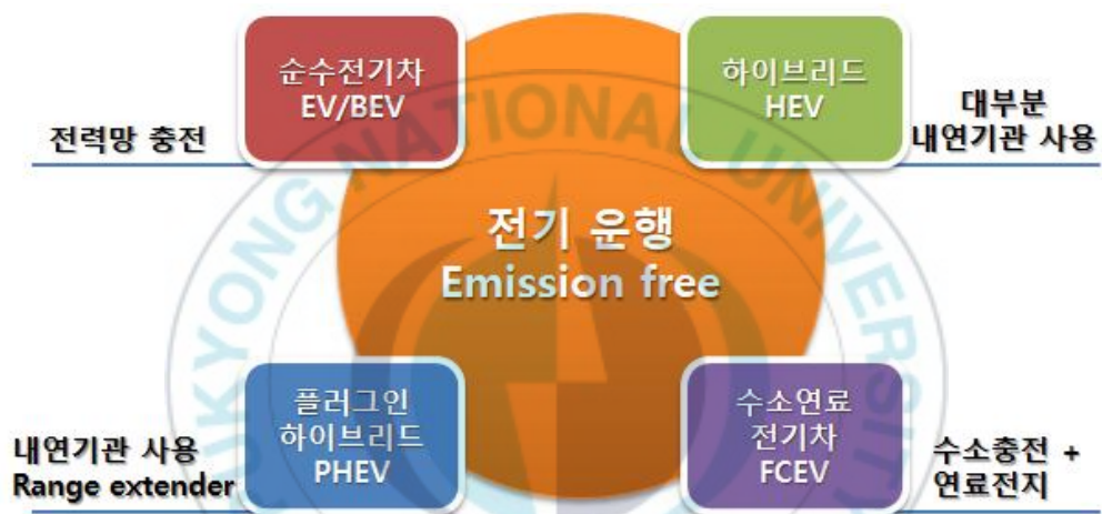
Fig. 2.1 동력원에 따른 전기자동차의 분류
