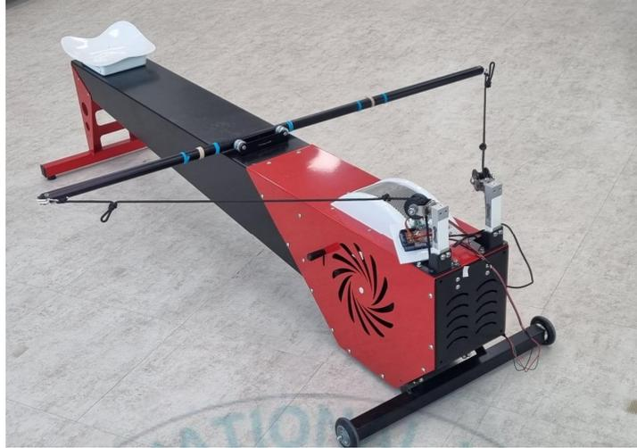
그림 4. 자체 제작된 카약 에르고미터(IMPACTRAK, MarineX, ROK)
