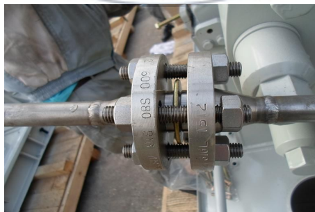
Fig. 3.7 Bolt/Nut 부적합 사례의 예시
