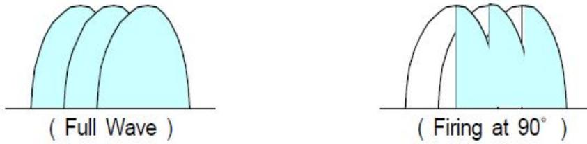
[그림7] SCR Gate Firing 각도에 따른 Converter 출력파형
