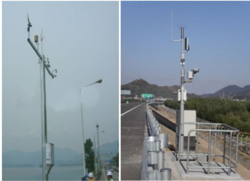
그림2.4 한국 ELP사의 도로 기상 관측 시스템.
