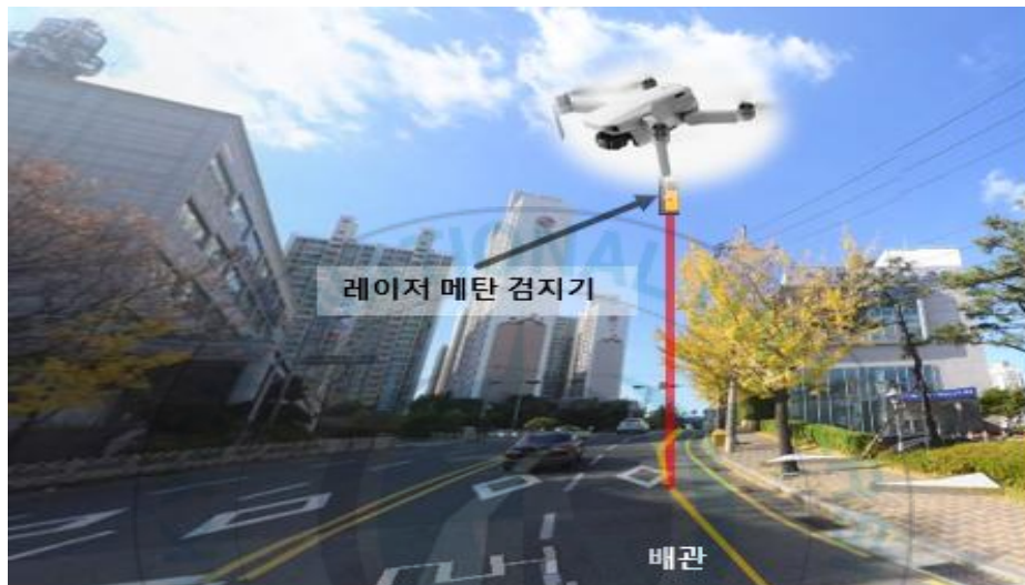
<그림 4-6> 드론과 레이저 메탄 검지기를 활용한 가스 누설검사
