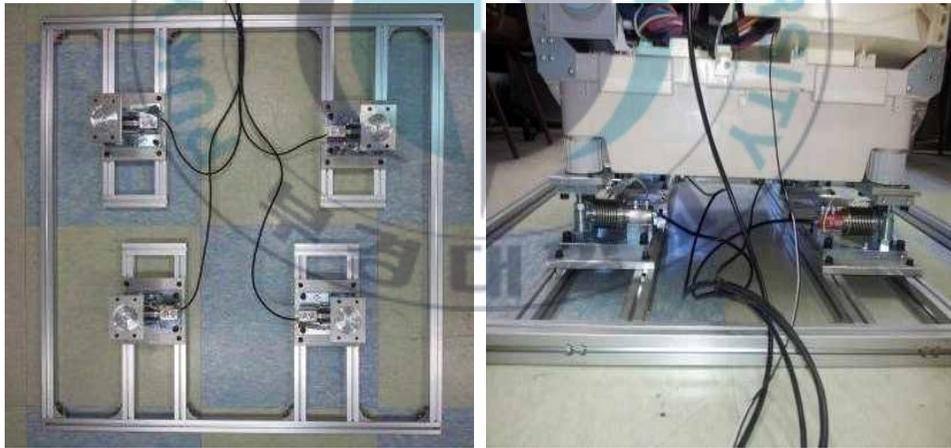
Fig. 4.5 로드셀 받침대 및 장착 모습
