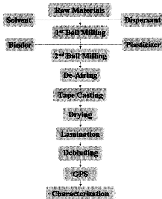
그림 7. \text{Si}_3\text{N}_4 기판 제조의 전체 공정
