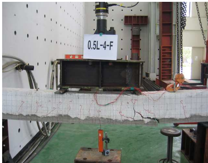
사진 4.11 0.5L-4-F 시험체의 최종파괴모습
