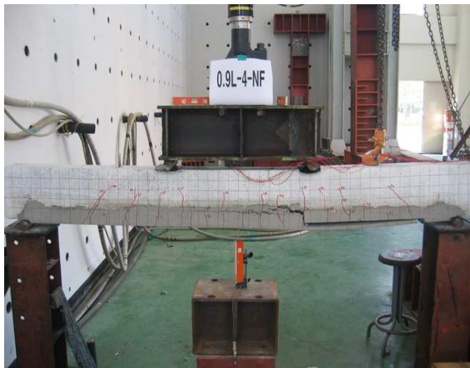
사진 4.7 0.9L-4-NF 시험체의 최종파괴모습
