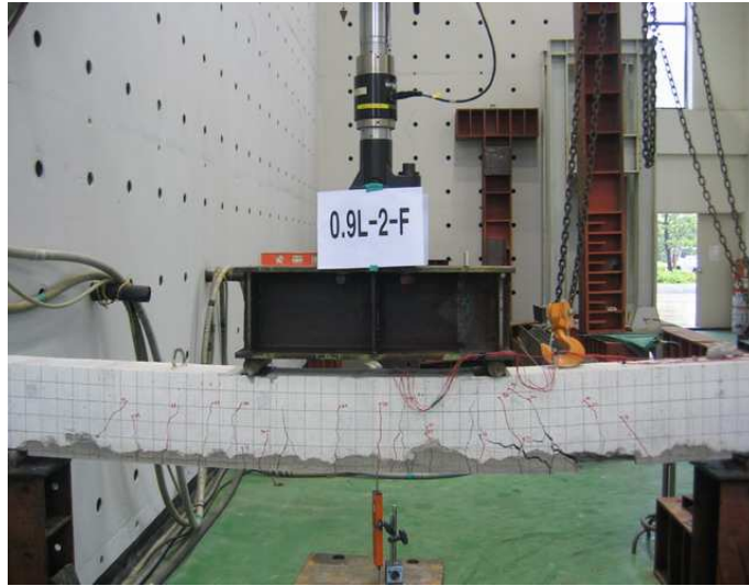
사진 4.10 0.9L-2-F 시험체의 최종파괴모습
