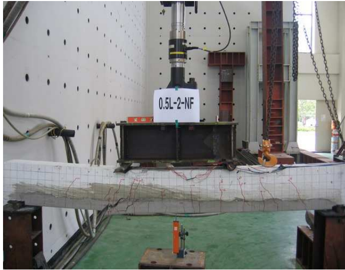
사진 4.2 0.5L-2-NF 시험체의 최종파괴모습
