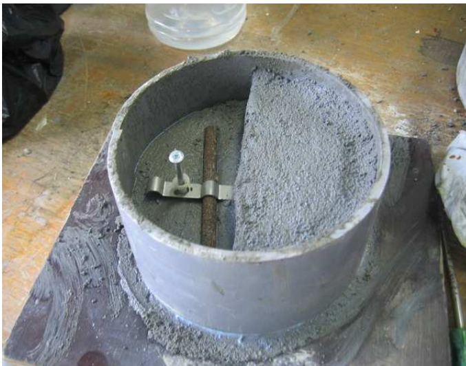
(g) 앵커에 의한 CFRP bar의 정착
