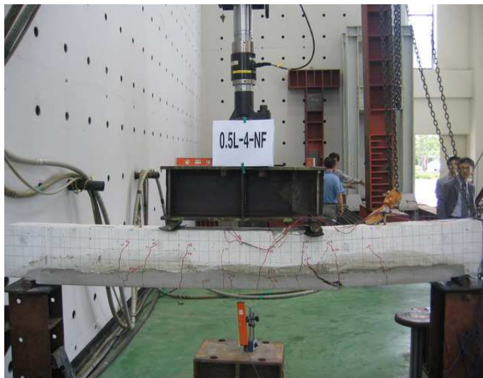
사진 4.5 0.5L-4-NF 시험체의 최종파괴모습
