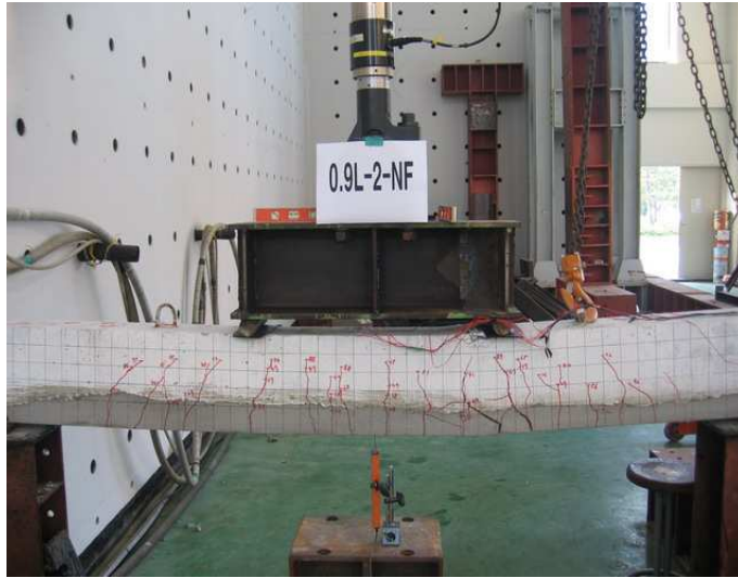
사진 4.4 0.9L-2-NF 시험체의 최종파괴모습
