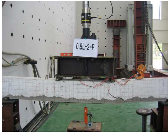
사진 4.8 0.5L-2-F 시험체의 최종파괴모습
