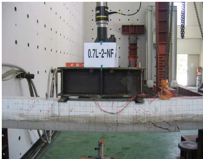
사진 4.3 0.7L-2-NF 시험체의 최종파괴모습
