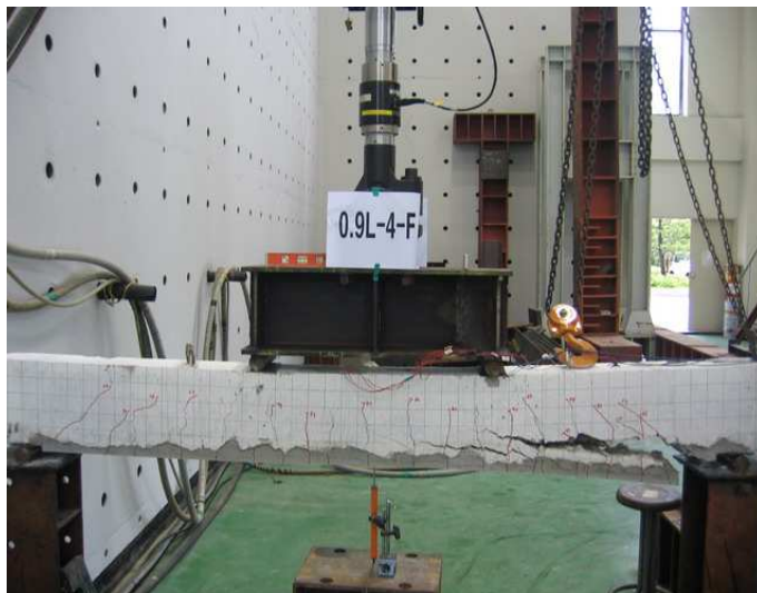
사진 4.13 0.9L-4-F 시험체의 최종파괴모습
