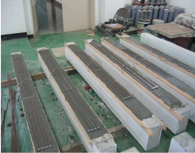
(d) 가넷을 살포한 CFRP bar 설치과정
