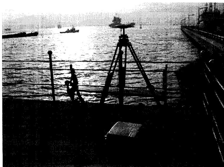
<그림 3.5> 관측대상지역의 GPS 기준점 측위 모습
