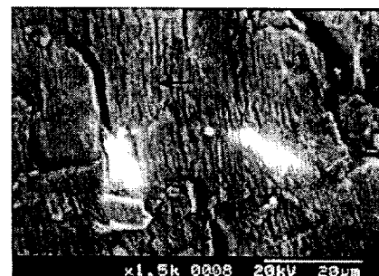
(f) Temp. : 1300°C crack length : 35mm
