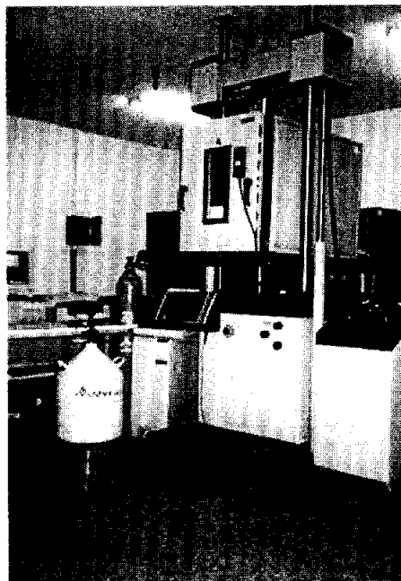
Fig. 13 Apparatus of fatigue test machine(Instron, 8501)
