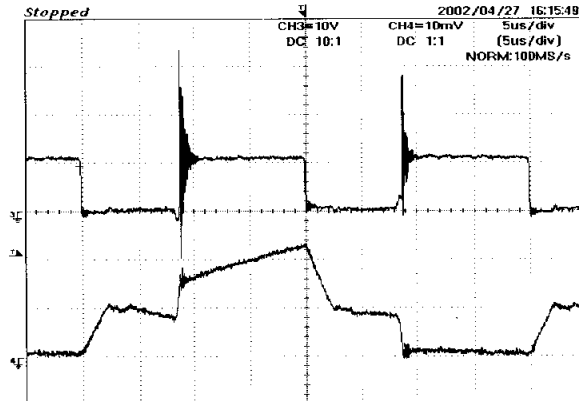
그림 4-11. 변압기 2차측 다이오드정류기 출력전압과 다이오드전류 파형(50V/div, 50A/div)
