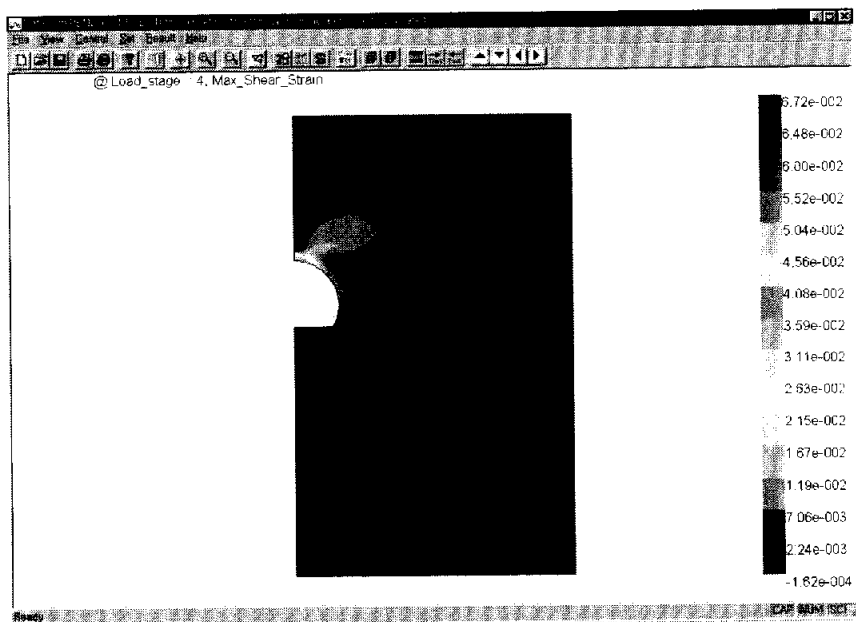
<그림 5.6(c)> 하반굴착 후의 최대전단변형률 (STA.12K+520.0, 무보강)
