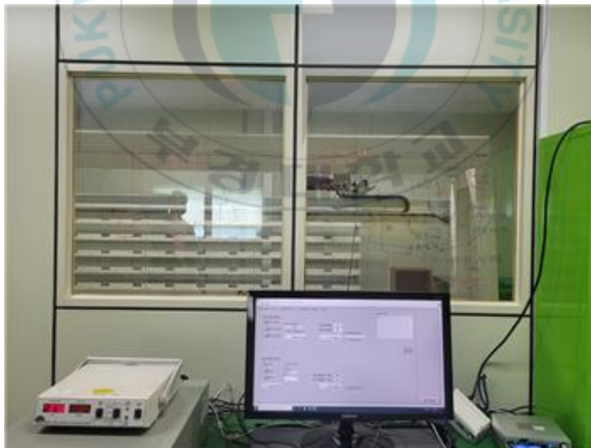
<그림 3.9> 연엑스선 정전기 제거장치 성능측정을 위한 차폐 챔버
