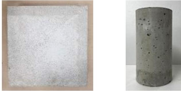
그림 3.6 콘크리트 시험체 형상
