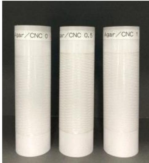
그림 III-3. Agar/CNC 나노복합체 섬유(왼쪽부터 Control agar, agar/CNC0.5, agar/CNC1 섬유).
