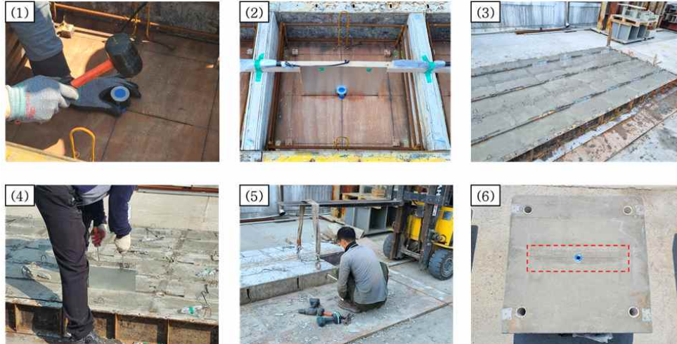
그림 4.2 균열 콘크리트 블록 제작과정
