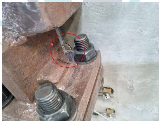
그림 5.8 반복하중 가력단계 중 ETAG 가력프로토콜을 적용한 실험체에서 관찰된 균열
