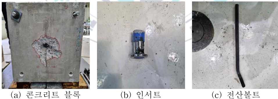
그림 5.9 ACI 및 ETAG 가력프로토콜을 적용한 반복 전단실험 종료 후 관찰된 실험체 모습
