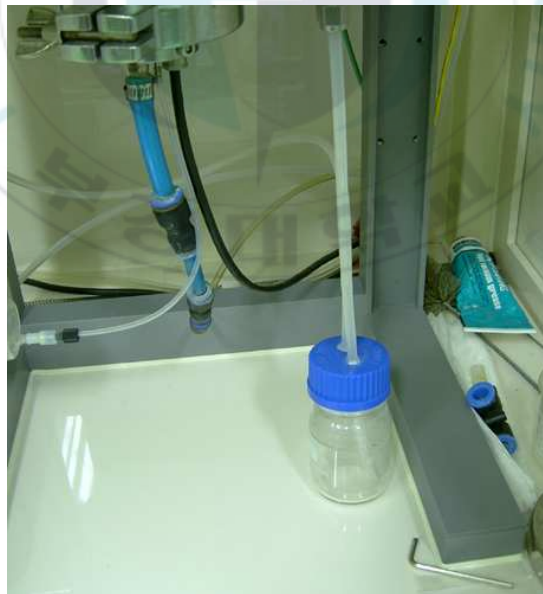
그림 12. source drain line과 배출된 용액을 모으는 용기
