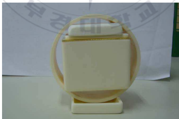
그림 22. 열처리를 위해 제작된 알루미나 특수 용기. 알루미나와 금의 열팽창 계수가 다른 점을 이용하여 고온에서 우수하게 밀폐된다.
