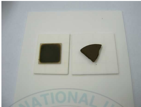
그림 23. precursor film(좌)과 Tl source(우)
