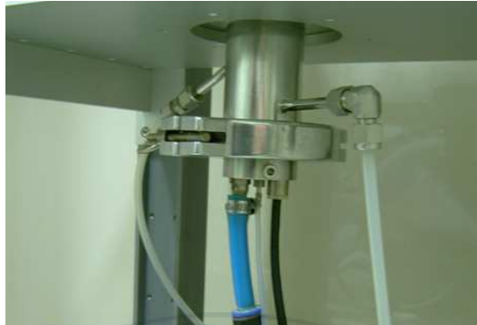
그림 11. source drain line
