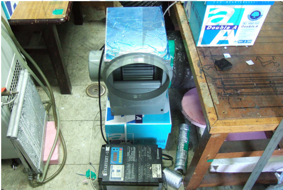
Fig. 10 Blower(LG, 1200W, 3800CMH), Invertor
