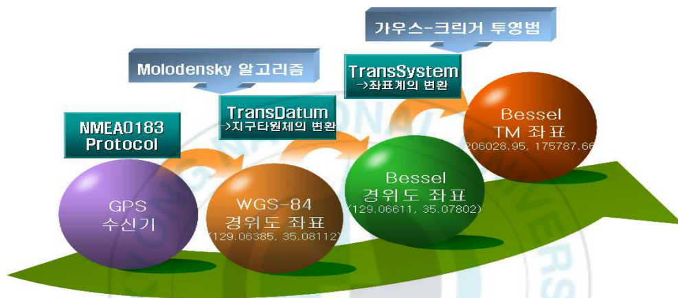
[그림 17] GPS수신기 데이터에서 TM좌표로의 변환 과정
