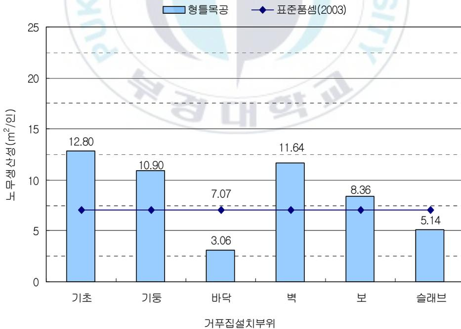
그림 3.14 거푸집 설치 부위별 형틀목공 생산성
