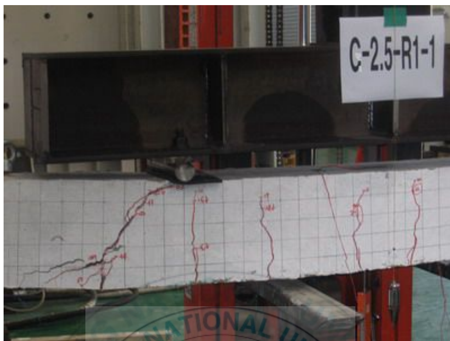
< 사진 3-17 > C-2.5-R1-1 시험체의 최종 파괴 모습
