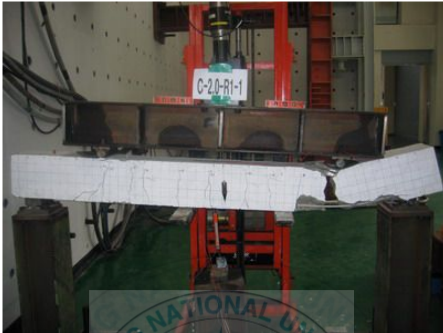
< 사진 3-11 > C-2.0-R1-1 시험체의 최종 파괴 모습
