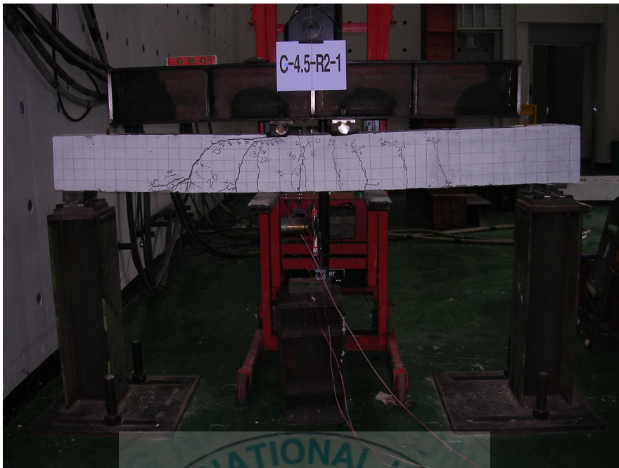
< 사진 3-30 > C-4.5-R2-1 시험체의 최종 파괴 모습
