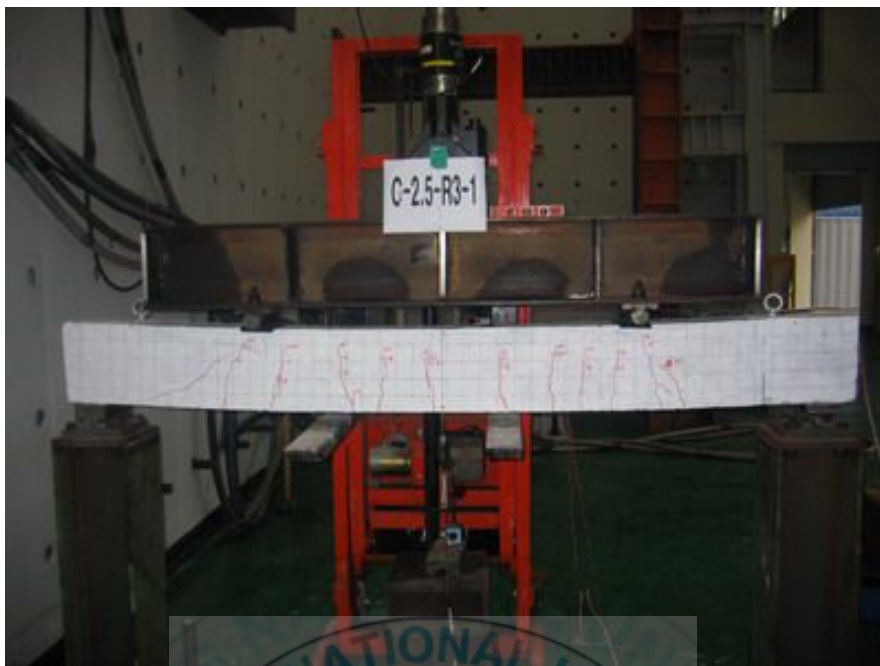
< 사진 3-21 > C-2.5-R3-1 시험체의 최종 파괴 모습
