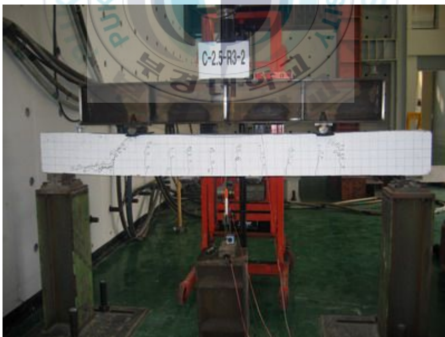
< 사진 3-22 > C-2.5-R3-2 시험체의 최종 파괴 모습
