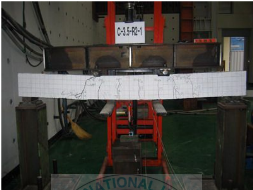
< 사진 3-25 > C-3.5-R2-1 시험체의 최종 파괴 모습
