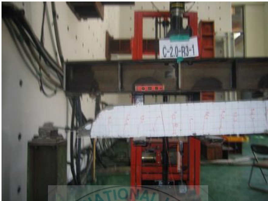
< 사진 3-15 > C-2.0-R3-1 시험체의 최종 파괴 모습
