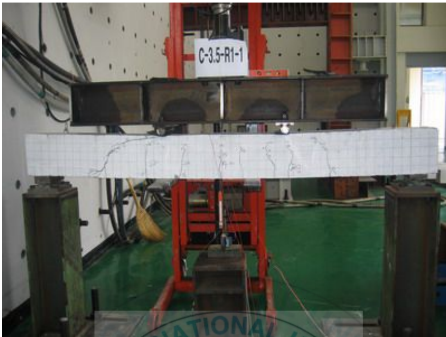
< 사진 3-23 > C-3.5-R1-1 시험체의 최종 파괴 모습
