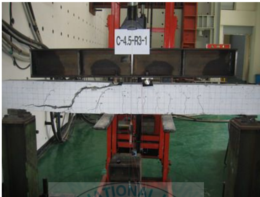
< 사진 3-31 > C-4.5-R3-1 시험체의 최종 파괴 모습
