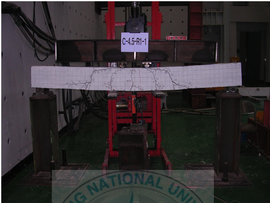
< 사진 3-29 > C-4.5-R1-1 시험체의 최종 파괴 모습
