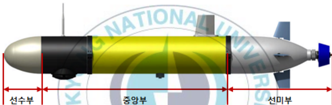
그림 1. AUV의 외형 및 치수
