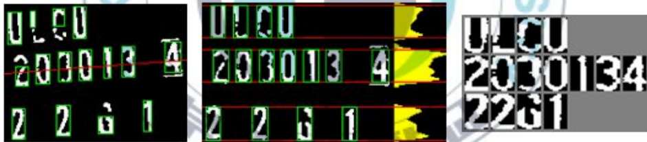
<그림 29> 한 문자가 여러 조각으로 분리된 상태에서의 처리
