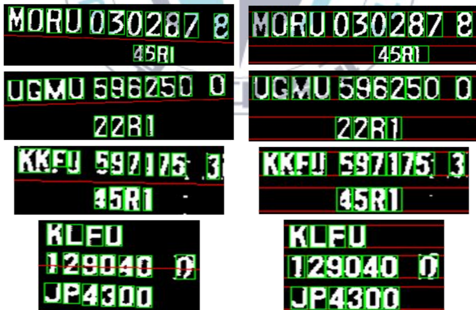
<그림 28> 레이블링을 이용한 기울기 보정 알고리즘의 결과
