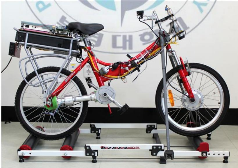
그림 4.9 주행시험 중인 자전거 로봇의 전체 모습
