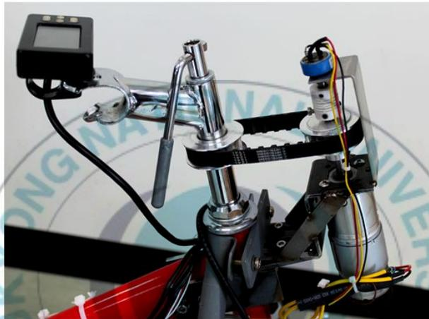
그림 4.5 핸들각 제어를 위한 Potential Meter의 설치
