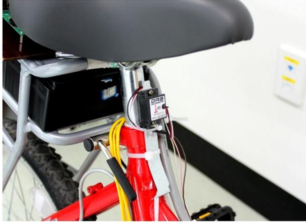
그림 4.6 기울기각 검출을 위한 Tilt Sensor의 설치
