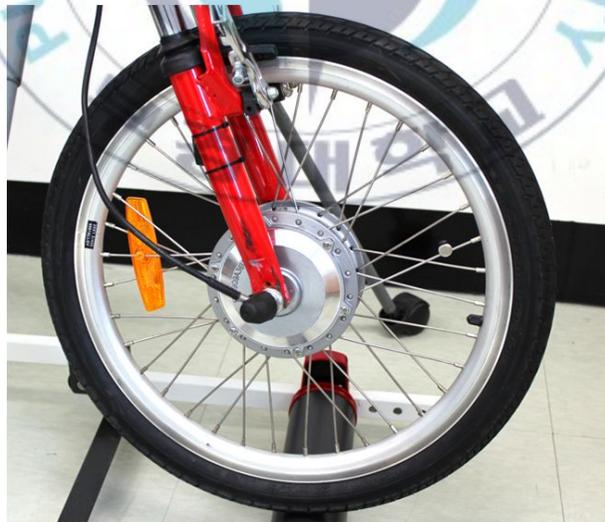
그림 4.7 BLDC Wheel Hub Motor 장착
