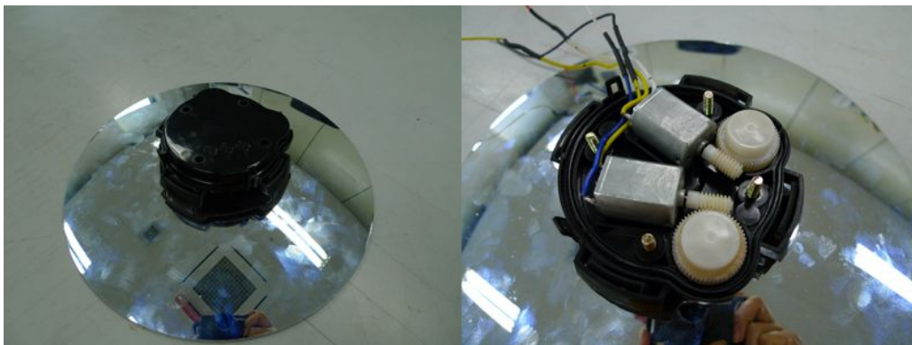
그림 4.9 X-Y 액츄에이터 구조
