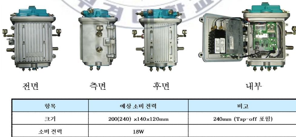
[그림 3-5] Tap-off 일체형 Smart-AP 장비 형상도 및 재원
