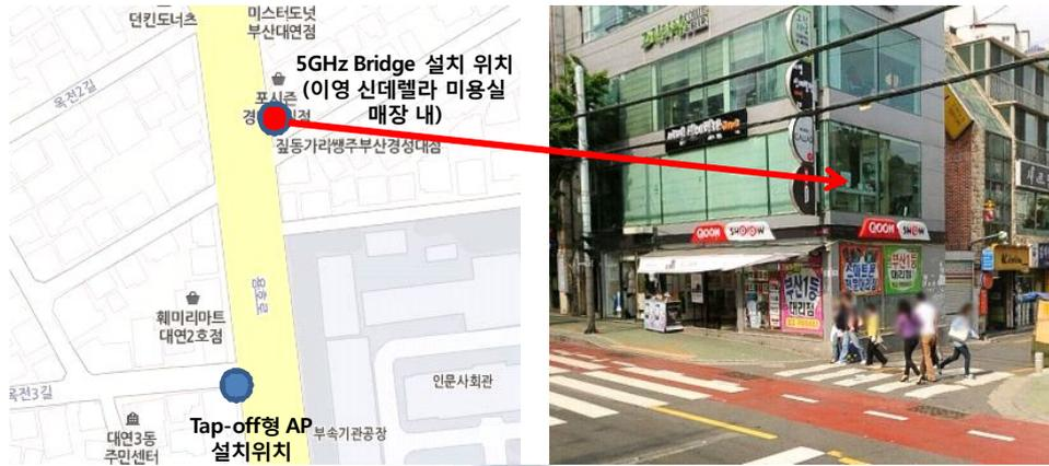
[그림 4-6] 부경대학교 앞 Tap-off 일체형 Smart-AP와 Indoor Smart-AP의 현장 시험망 구성
