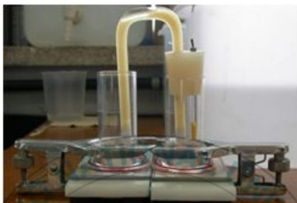
Fig. 12. 실제 노이즈 측정 cell 구성 모습
