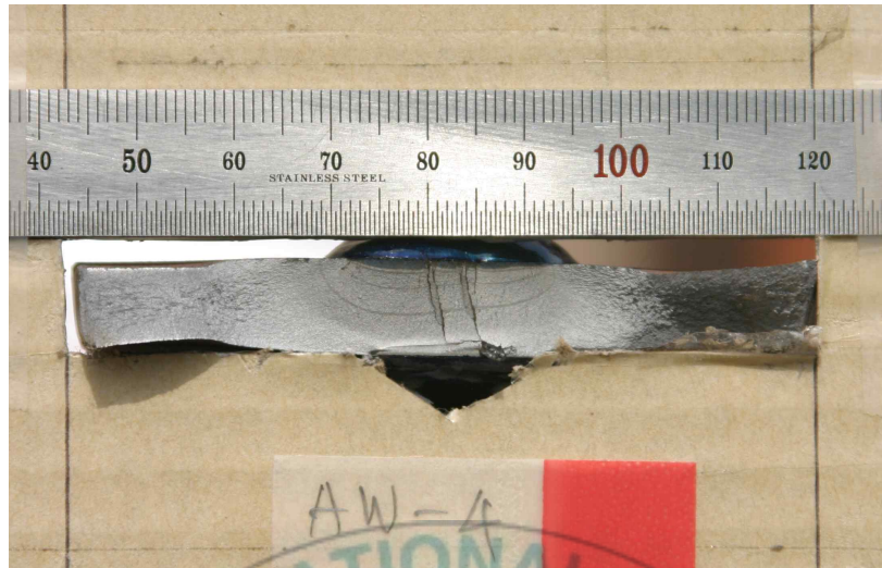
(a) AW시험체 피로 파단면( \Delta\sigma=200 MPa)
